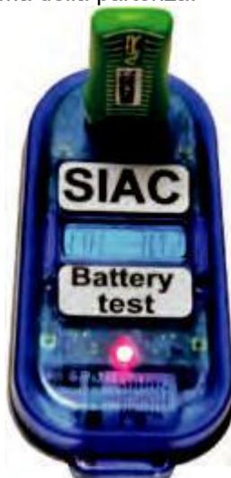
La funzionalità AIR+ della SIAC non è sempre attiva, in modo da ridurre il consumo di batteria. La funzionalità viene attivata con il punzonamento della stazione CHECK dopo la pulizia del chip, e viene spenta con la punzonatura del FINISH.
