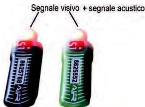
Il consumo di batteria della SIAC è estremamente basso. La durata della batteria è di circa 4 anni con un utilizzo per circa 40 gare l'anno. La batteria SIAC può essere sostituita da un operatore qualificato.
